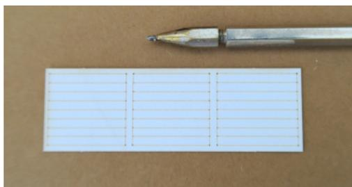
Avant la mise en place de cette plate-forme, vous pouvez approfondir les traits de gravure avec une pointe à tracer, pour donner plus de relief au plancher.
